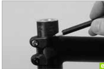
**f** Demontieren Sie die Gabel komplett aus dem Steuerrohr des Rahmens. Achten Sie dabei auf die Lage der Bauteile und legen Sie diese der Reihe nach ab.
