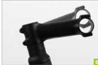
**f** Nehmen Sie den Deckel und den Lenker ab. Ziehen Sie den Vorbau vom Gabelschaft und drehen Sie den Vorbau um 180°. Bestreichen Sie die Vorbauklemme innen und den Gabelschaft außen dünn mit frischer Carbon-Montagepaste.
