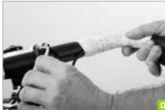
**p** Erhöhen Sie das Drehmoment auf den Maximalwert, den der Vorbau oder der Lenker zulassen. Der geringere Wert zählt dabei.
