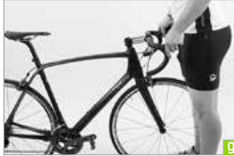
**h** Gelingt dies, lösen Sie die seitlichen Schrauben wieder und richten Sie den Lenker samt dem Vorbau, wie vorstehend beschrieben, neu aus. Drehen Sie die Schrauben mit dem höheren Wert innerhalb der Drehmomentspanne fest.
