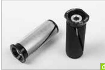
Beachten Sie, dass es die aktuellen Expander in zwei Durchmessern gibt. Verwenden Sie ausschließlich das neue Modell im passenden Durchmesser. Das erkennen Sie daran, dass sich der Expander nur satt einschieben lässt.
