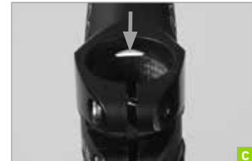
**d** Oben und unten sollte innen im Vorbau ein Bund von mindestens 7 mm vorhanden sein. Messen Sie diese Bereiche nach. Hintergrund ist, dass zwischen Oberkante Gabelschaft und Oberkante Vorbau 2 bis 3 mm Höhendifferenz vorgesehen werden müssen, damit das Lenkungs-lager eingestellt werden kann.
