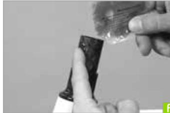
**g** Schieben Sie den Vorbau auf den Gabelschaft, ggf. inklusive 5 mm Spacer, legen Sie die Abdeckkappe auf den Vorbau und setzen Sie die Einstellschraube wieder an.
