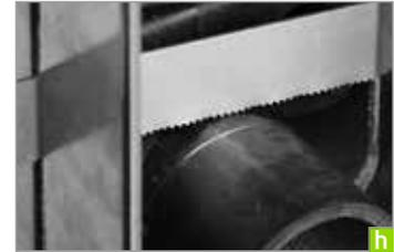
**i** Breiten Sie ein angefeuchtetes Tuch unterhalb des Gabelschaftes aus, so dass der Sägestaub darauf rieseln kann. Kürzen Sie den Schaft mit einem speziellen Carbonsägeblatt oder einem frischen, d.h. sehr scharfen, Metallsägeblatt mit 24T-Zahnung.
