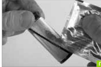
**s + t** Schieben Sie den Mechanismus hinein, bis der Deckel aufliegt. Der Schriftzug FRONT muss in Fahrtrichtung nach vorne zeigen. Halten Sie den Deckel mit einem 24 mm Maulschlüssel fest und drehen Sie die innen liegende Schraube mit 8 Nm an.
