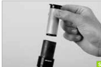
**u** Schieben Sie den Vorbau auf, montieren Sie den Ahead®-Deckel und justieren und befestigen Sie den Vorbau, wie im Kapitel „Lenkungs-lager kontrollieren und einstellen“ beschrieben.
