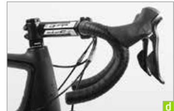
**e** Reichen die Verstellmöglichkeiten nicht aus, können Sie die meisten Vorbauten umdrehen. So genannte Flip-Flop-Vorbauten bieten dadurch zwei unterschiedliche Lenkerhöhen. Beachten Sie, ob die Züge dazu lang genug sind. Lösen Sie die vorderen Schrauben der Lenkerklemmung vollständig.
