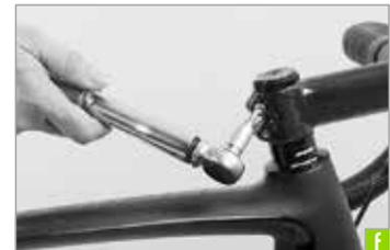
Commencez par 4 Nm, puis augmentez progressivement le couple jusqu'à un demi newtonmètre afin de bien serrer la potence sur la fourche ou jusqu'à atteindre le couple maximal admissible pour la potence. Vous ne devez en aucun cas dépasser un couple de 6 Nm.
