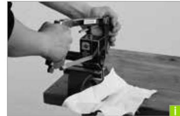
Sciez en exerçant peu de pression pour ne pas détacher les fibres dans le tube du pivot. Ne nettoyez pas le copeaux en soufflant dessus ou en les balayant, mais nettoyez la découpe avec le chiffon humide.
