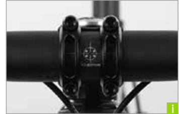
**k** Resserrez les vis de manière à fixer légèrement le cintre. Alignez le cintre jusqu'à ce que ses extrémités soient à l'horizontale ou légèrement orientées vers le bas. Les poignées de frein sont alors horizontales au niveau de la zone de préhension.
