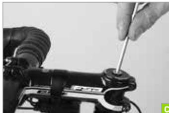
**b** Desserrez les vis de serrage sur le côté de la potence jusqu'à pouvoir tourner légèrement la potence par rapport à la fourche. Deux à trois tours suffisent généralement. Il ne faut en aucun cas desserrer entièrement ces vis.
