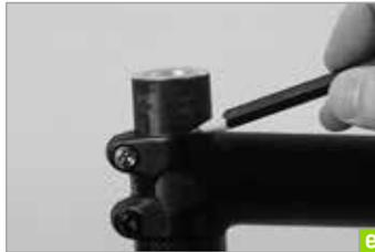
**f** Démontez entièrement la fourche du tube de direction du cadre. Lors de cette opération, faites attention à la position des pièces et déposez-les les unes après les autres.
