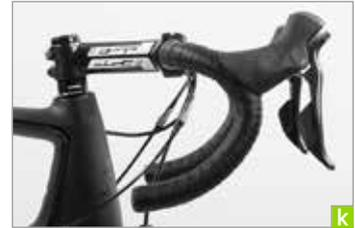
**l** Puis resserrez les vis du capuchon de potence en procédant avec précaution et progressivement jusqu'à ce que la fente de serrage soit de la même largeur et parallèle en haut et en bas.
