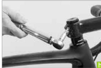
**i** Si ce couple ne suffit pas, il peut être judicieux de démonter la potence, de nettoyer minutieusement toutes les surfaces de serrage avec un chiffon absorbant et d'y appliquer de la pâte de montage pour composants carbone neuve.
