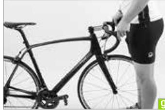
**h** Si vous y arrivez, redesserrez les vis latérales et réalignez le cintre, potence comprise, comme décrit plus haut. Serrez les vis au couple supérieur de la plage de serrage.
