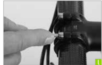
**m** Prenez la clé dynamométrique et serrez les vis à un newtonmètre de moins que le maximum gravé, en alternant.
