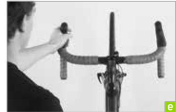
**f** Serrez progressivement les vis de serrage sur le côté de la potence. Utilisez une clé dynamométrique et observez les couples de serrage prescrits.
