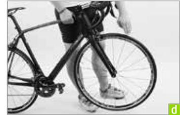
**e** Procédez au contrôle et à l'ajustement jusqu'à ce passer avec succès les deux contrôles. Si le jeu de direction fonctionne sans jeu et facilement, alignez la potence. Prenez la potence comme repère pour la roue avant pour savoir si le cintre est bien droit.
