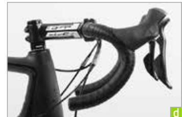
**e** Si les possibilités de réglage ne suffisent pas, vous avez la possibilité de tourner la plupart des potences. Les potences réversibles vous offrent ainsi deux hauteurs de cintre. Vérifiez si les câbles sont assez longs pour cette opération. Desserrez entièrement les vis à l'avant du serrage du cintre.
