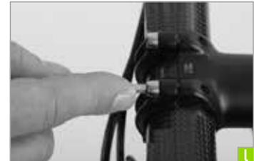
**m** Prendere la chiave dinamometrica e serrare le viti a un newton metro in meno rispetto al massimo stampato sul componente e incrociando.
