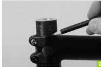
**f** Smontare completamente la forcella dal tubo di sterzo del telaio. Durante l'operazione fare attenzione alla posizione dei componenti e appoggiarli disponendoli nello stesso ordine.
