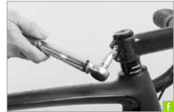
Iniziare da 4 Nm e aumentare la coppia di serraggio gradualmente di mezzo newton metro per volta fino a quando l'attacco manubrio è fissato saldamente sulla forcella o fino a raggiungere la coppia di serraggio massima consentita dell'attacco manubrio. Non superare mai i 6 Nm.
