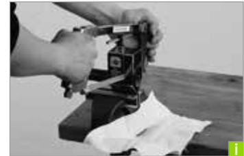
Applicare una leggera pressione durante il taglio con la sega per evitare di staccare le fibre all'interno del tubo del canotto. Non soffiare o spazzolare i trucioli, ma pulire l'area di taglio con un panno umido.
