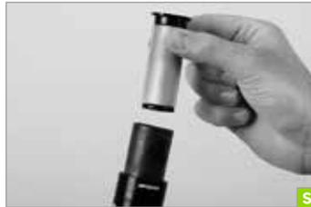
**u** Inserire l'attacco manubrio, montare il coperchio Ahead®, quindi regolare e fissare l'attacco manubrio come descritto nel capitolo «Controllo e regolazione della serie sterzo».
