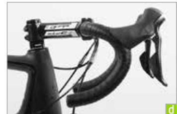
**e** Se le regolazioni non sono sufficienti, è possibile capovolgere la maggior parte degli attacchi manubrio. I cosiddetti attacchi manubrio flip-flop permettono quindi di ottenere due diverse altezze del manubrio. Controllare se i cavi sono abbastanza lunghi a tale scopo. Svitare completamente le viti anteriori del morsetto del manubrio.
