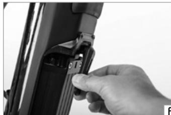
Continuez à tenir la batterie. Une pression sur le bouton à l'extrémité supérieure de la batterie permet ensuite de la déverrouiller (h).
