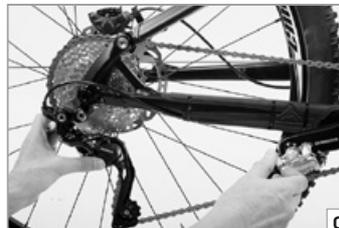
6. Vérifiez si la chaîne est encore engagée sur les plateaux et les pignons. Si votre VAE MERIDA est tombé du côté des dérailleurs, vérifiez leur fonctionnement. Demandez à une personne de soulever votre VAE MERIDA au niveau de la selle et passez les vitesses une à une avec précaution. Surveillez notamment l'écart du dérailleur arrière par rapport aux rayons dans les petites vitesses, c'est-à-dire quand la chaîne est engagée sur les plus gros pignons **(c+d)**.
