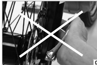
Pour contrôler la fiabilité du serrage, appuyez latéralement sur l'extrémité du levier fermé et essayez de le faire pivoter autour de l'axe de l'attache. S'il bouge, ouvrez de nouveau le levier et augmentez la précontrainte sur l'axe de l'attache rapide. Pour cela, tournez l'écrou de réglage, sur le côté opposé, d'un demi-tour dans le sens des aiguilles d'une montre. Fermez de nouveau le levier et contrôlez la fiabilité du serrage.
