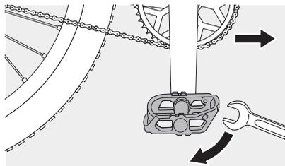
Setzen Sie die Achse des rechten Pedals von Hand an und drehen Sie es etwas im Uhrzeigersinn ein. Ziehen Sie es dann mit einem Pedalschlüssel bzw. einem langem 15 mm Maulschlüssel fest.
