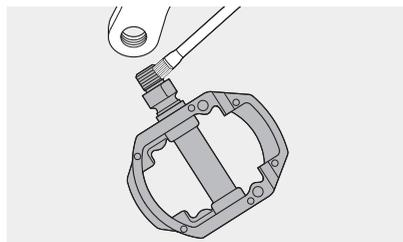
Streichen Sie die Kurbelarmgewinde, das Gewinde und die Auflagefläche der Pedalachsen mit einer Montagepaste ein.
