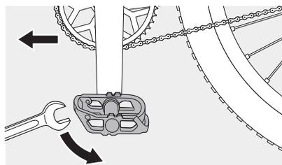
Das linke Pedal hat ein Linksgewinde. Drehen Sie die Achse gegen den Uhrzeigersinn ein und ziehen es anschließend mit dem Pedalschlüssel fest.
