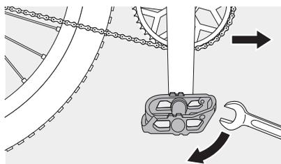
Inserte el eje del pedal derecho manualmente y gírelo ligeramente en sentido horario. A continuación, apriételo con una llave para pedales o una llave de boca de 15 mm de longitud.
