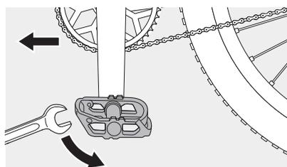
El pedal derecho tiene la rosca a izquierdas. Atornille el eje en sentido antihorario y, continuación, apriételo con una llave para pedales.
