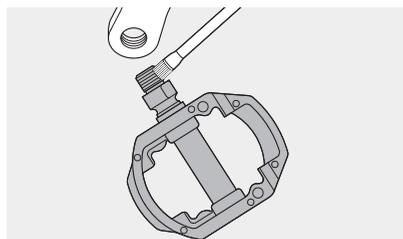
Aplique pasta de montaje en las roscas del brazo de la biela, así como en las superficies de contacto de los ejes de los pedales.
