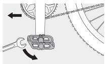
La pédale de gauche possède un filet à gauche. Vissez l'axe dans le sens contraire des aiguilles d'une montre, puis serrez la pédale à l'aide de la clé à pédales.
