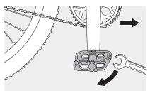
Introduisez l'axe de la pédale de droite à la main et tournez-la légèrement dans le sens des aiguilles d'une montre. Serrez-la ensuite à l'aide d'une clé à pédale ou d'une longue clé plate de 15 mm.
