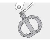
Appliquez de la pâte d'assemblage sur les filets des manivelles, ainsi que sur les filets et les surfaces de contact des axes des pédales.
