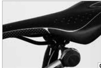
Se o selim for adequado, coloque-o no espigão de tal forma que a armação fique presa centralmente **(f)** pelo mecanismo de aperto do espigão. Além disso, ajuste o canto superior do selim paralelamente ao chão. Aperte o parafuso gradualmente e certifique-se de que
