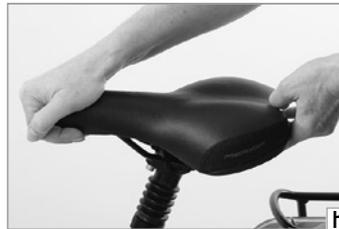
Bei einer **Joch-Klemmung (f)** mit zwei hintereinander liegenden Schrauben lösen Sie die beiden Schrauben zwei bis maximal drei Umdrehungen, sonst kann der gesamte Mechanismus auseinanderfallen. Verschieben Sie den Sattel horizontal, um die Sitzlänge einzustellen. Oft ist hierzu ein kleiner Klaps auf den Sattel notwendig. Achten Sie auf die Markierungen am Gestell und überschreiten Sie diese nicht.
