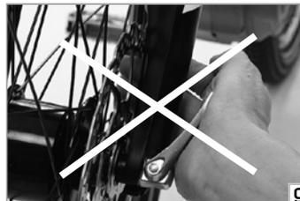
Überprüfen Sie den Sitz, indem Sie auf das Ende des geschlossenen Hebels drücken und versuchen, ihn zu verdrehen. Bewegt er sich, müssen Sie ihn öffnen und die Vorspannung erhöhen. Drehen Sie die Klemmmutter auf der Gegenseite im Uhrzeigersinn um eine halbe Umdrehung. Schließen Sie den Schnellspanner und überprüfen Sie den Sitz erneut.
