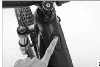
4. Ihr MERIDA Pedelec ist mit einer Schiebehilfe **(f)** ausgestattet. Die Schiebehilfe erleichtert Ihnen das Schieben Ihres MERIDA Pedelecs. Sind Sie mit der Schiebehilfe vertraut?
