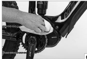
Tragen Sie auf die möglichst blanken Kettenglieder Kettenöl, -fett oder -wachs (b) auf. Drehen Sie dabei die Kurbel und beträufeln Sie die Rollen auf der Innenseite der Kette. Drehen Sie anschließend die Kette mehrere Umdrehungen durch. Lassen Sie das MERIDA Pedelec einige Minuten stehen, damit der Schmierstoff in die Kette eindringen kann. Reiben Sie dann das überschüssige Schmiermittel mit einem Lappen ab, damit es beim Fahren nicht spritzt oder unnötig Schmutz anzieht.
