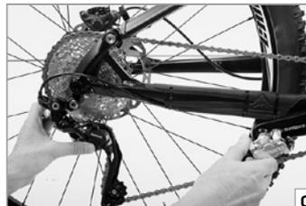
Réajustez éventuellement les composants et resserrez les vis avec précaution jusqu'à obtenir un serrage fiable des composants **(b)**. Les couples de serrage maximum à appliquer sont en règle générale gravés sur les composants eux-mêmes ou indiqués dans les notices techniques des équipementiers.
