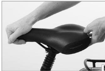
Sur une **fixation de la selle (f)** par deux vis placées devant et derrière la tige de selle, desserrez les deux vis de deux à trois tours maximum pour ne pas disloquer complètement le dispositif de fixation. Avancez ou reculez la selle horizontalement pour régler la distance par rapport à la potence, en tapotant légèrement sur la selle si nécessaire. Tenez compte des repères sur les rails de la selle et veillez à ne pas les dépasser.
