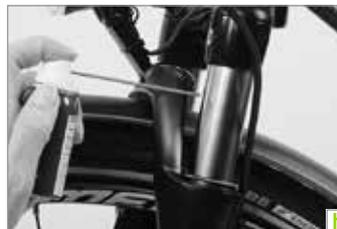
3. Besprühen Sie die Standrohre der Federgabel, nachdem Sie Ihr Fahrrad gewaschen haben, mit etwas Schmier Spray (h) oder tragen Sie eine sehr dünne Schicht Hydrauliköl auf. Federn Sie die Gabel dann mehrfach ein und wischen Sie die Schmiermittelreste vor der nächsten Fahrt mit einem sauberen Lappen ab.
