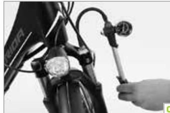
Notieren Sie sich passende Einstellwerte und überprüfen Sie diese in der Folgezeit regelmäßig. Beachten Sie stets die Empfehlungen des Herstellers und überschreiten Sie keinesfalls den maximalen Federgabel-Luftdruck. Führen Sie nach jeder Änderung der Einstellung eine Probefahrt durch.
