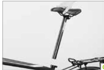
Demontieren Sie die Sattelstütze (c) und lassen Sie eventuell eingedrungene Feuchtigkeit austrocknen. Sprühen Sie etwas fein zerstäubtes Öl ins Sattelrohr aus Metall, nicht jedoch bei einem Carbonrahmen. Schalten Sie vorne auf das kleine Blatt und hinten auf das kleinste Ritzel. So sind Züge und Federn entspannt.
