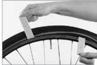
Ist ein Teil der Reifenflanke über den Felgenrand gehoben, können Sie sie meist problemlos über den gesamten Umfang lösen, indem Sie einen Montierhebel verschieben. Nun können Sie den Schlauch herausnehmen. Passen Sie auf, dass das Ventil nicht in der Felge hängenbleibt und der Schlauch nicht weiter beschädigt wird. Die zweite Reifenflanke können Sie bei Bedarf einfach herunterziehen.
