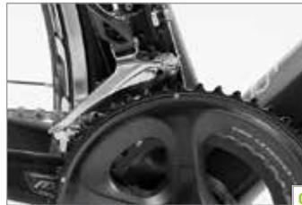
Beim vorderen Umwerfer kann sich, genau wie beim Schaltwerk, der Zug längen. Das Schaltverhalten verschlechtert sich. Schalten Sie aufs kleine Kettenblatt und spannen Sie bei Bedarf den Zug an der Schraube nach, durch die der Bowdenzug am Rahmenanschlagn läuft.
