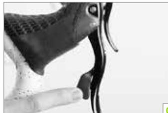
Bei **Campagnolo Ergopower** schalten Sie mit dem hinter dem Bremshebel liegenden Hebel auf die größeren Kettenblätter bzw. Ritzel, indem Sie ihn mit dem Zeige- oder Mittelfinger nach innen schwenken. Drücken Sie mit dem Daumen auf die Taste innen am Griffkörper, wird die Kette auf die kleineren Kettenblätter bzw. Ritzel befördert. Pro Betätigung können Sie maximal zwei Kettenblätter bzw. drei Ritzel schalten.
