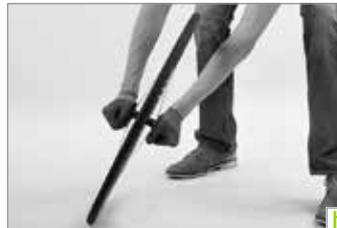
Ziehen Sie den Reifen abermals oben am Ventil beginnend nach unten, bis Sie mit den Händen an der noch zu montierenden Stelle sind.
