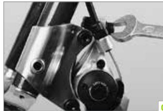
Lösen Sie die Überwurfmutter an der Schraube, durch die der Zug in den Bremssattel läuft **(d)**, und drehen Sie die Schraube heraus, bis der Hebelweg Ihren Ansprüchen genügt. Drehen Sie die Kontermutter wieder fest und achten Sie darauf, dass der Schlitz der Schraube nicht nach vorne steht, sonst dringt unnötig viel Schmutz und Feuchtigkeit ein. Bei manchen Modellen muss zudem direkt am Bremssattel innen nachgestellt werden.
