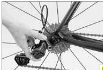
Bei **Scheibenbremsen** (hydraulisch oder mechanisch) sollten Sie vorher im Sichtfenster schauen, wo die Bremsbeläge sitzen. Später können Sie daran erkennen, ob die Beläge nach der Demontage noch an der dafür vorgesehenen Stelle sind. Lesen Sie die Bedienungsanleitung des Bremsenherstellers durch.
