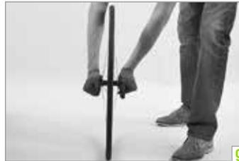
Umgreifen Sie den Reifen mit den Händen gleichmäßig links und rechts des Ventils, ziehen Sie ihn sehr kräftig nach unten und heben Sie ihn Stück für Stück in das Felgenbett (e). Fahren Sie gleichmäßig fort, bis noch etwa 20 Zentimeter verbleiben.
