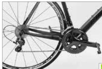
Schalten Sie vorsichtig auf das größte hintere Ritzel (f) und überprüfen Sie, ob die Leitrolle des Schaltwerks genau unter den Zahnsitzen des Ritzels liegt. Drehen Sie die mit „L“ markierte Schraube im Uhrzeigersinn, bis sich das Schaltwerk nicht mehr weiter in Richtung Speichen bewegen lässt – weder durch Betätigen des Schalthebels noch durch Druck mit der Hand (g). Drehen Sie bei der Kontrolle langsam und vorsichtig an der Kurbel.
