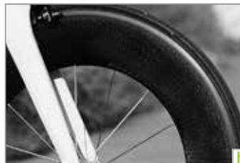
Tubeless-Reifen können mit etwas weniger Druck als Drahtreifen gefahren werden. 75 kg schwere Fahrer kommen in der Regel mit 7 bar zurecht, 65 kg schwere Fahrer mit 6 bar. 4,5 bar sollten in der Regel nicht unterschritten werden. Beachten Sie die Hinweise zum maximal zulässigen Druck auf der Reifenflanke.
