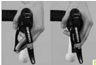
Bei den **Shimano, SRAM und Campagnolo Lenkerend-Schalthebeln** für den Triathlon- und Zeitfahrersatz müssen Sie den Schalthebel nach unten drücken, um hinten auf die kleineren Ritzeln, d.h. zur großen Übersetzung, und vorne auf die kleineren Kettenblätter, d.h. zu einer kleineren Übersetzung, zu schalten. Ziehen Sie den Schalthebel nach oben, können Sie hinten und vorne auf die größeren Kettenblätter bzw. Ritzel schalten.
