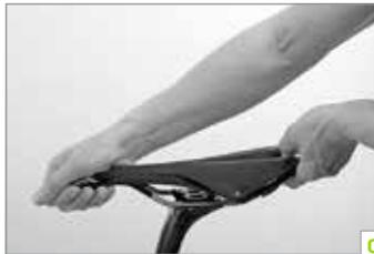
Nachdem Sie die gewünschte Position gefunden haben, überprüfen Sie, ob die beiden Hälften des Klemmmechanismus am Sattelgestell anliegen, bevor Sie das Schraubendrehmoment auf den vom Sattelstützenhersteller angegebenen Wert erhöhen.
