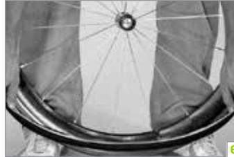
Wenn die oberste Schicht kurz abgelüftet hat, sich aber noch dickflüssig anfühlt, stellen Sie die Felge mit dem Ventilloch nach oben auf den Boden. Stecken Sie das Ventil des leicht aufgepumpten und dadurch runden Reifens ins Ventilloch der Felge und drücken es fest an. Achten Sie darauf, dass die Reifenflanken nicht mit dem Kittbett in Kontakt kommen, sonst sieht der Reifen sofort schmutzelig aus.
