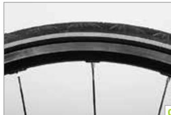
6. mit Reifen, deren Seitenwände **(d)** ringförmig zusammenhängend weiß oder gelb rückstrahlend sind, oder an jedem Rad mit nach beiden Seiten wirkenden Rückstrahlern oder Rückstrahlmaterialien, die den Bestimmungen der ECE-Regelung Nr. R 104 entsprechen, mit einer Lichteintrittsfläche von mindestens  $20 \text{ cm}^2$ ,
