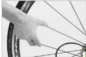
Das Gewicht des Fahrers und des Gepäcks sowie Fahrbahnunebenheiten belasten die Laufräder stark. Obwohl die Laufräder sorgfältig hergestellt und zentriert ausgeliefert werden, können sich Speichen und Nippel anfangs etwas lockern. Schon nach einer kurzen Einfahrzeit von etwa 100 bis 300 Kilometern bzw. 5 bis 15 Betriebsstunden sollten Sie Ihre Laufräder deshalb bei Ihrem MERIDA-Fachhändler kontrollieren und ggf. nachzentrieren lassen.
