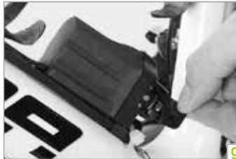
Bei **SRAM Force** Schalt-Bremsgriffen **(h)** gibt es nur einen Schalthebel, der hinter dem Bremshebel liegt. Schwenken Sie den Hebel komplett durch, schaltet das Schaltwerk ein bis zwei Kettenblätter bzw. drei Ritzel größer. Durch einen kurzen Schwenk wechselt die Kette zum nächst kleineren Kettenblatt bzw. Ritzel.
