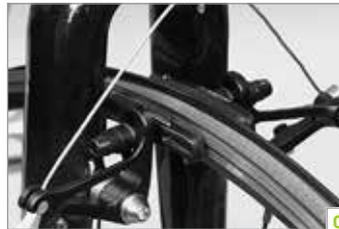
In keinem Fall darf sich der Bremshebel bis zum Lenkergriff ziehen lassen. Die Bremsbeläge sollten im gelösten Zustand auch nicht zu nahe an den Felgenflanken stehen, weil sie sonst beim Fahren an der Felge schleifen können. Bevor Sie diese Einstellung vornehmen, beachten Sie bitte die Hinweise im Kapitel „Regulieren der Bremshebel-Griffweite bei MERIDA Rennrädern“.
