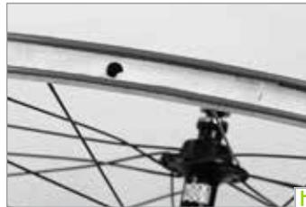
Nun können Sie den Schlauch herausnehmen. Passen Sie auf, dass das Ventil nicht in der Felge hängenbleibt und der Schlauch nicht weiter beschädigt wird. Die zweite Reifenflanke können Sie bei Bedarf einfach herunterziehen. Reparieren Sie den Schlauch gemäß der Anleitung des Flickenherstellers oder tauschen Sie ihn aus.
