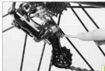
Tippen Sie zwei Mal auf eine Mode-Taste an einem Ergopower-Hebel, um wieder in den Fahrmodus zu gelangen. Die Kontrollleuchte am Interface bestätigt dies, indem diese blau blinkt. Schalten Sie vorsichtig die Gänge durch, bis die Kette auf dem größten Ritzel läuft. Wenn dies nicht sauber abläuft, müssen Sie abermals justieren.
