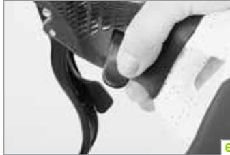
Die **Di2** ist die Elektronik-Version der hochwertigen Antriebsgruppen von **Shimano**. Anstelle von Seilzügen erfolgt die Signalübertragung mittels Kabeln. Schaltwerk und Umwerfer werden von kleinen Elektromotoren bewegt. Die Energieversorgung übernimmt ein am Rahmen oder in der Sattelstütze befestigter, wiederaufladbarer Akku **(g)**.
