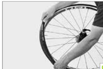
Achten Sie darauf, dass der Schlauch nicht zwischen Reifen und Felge eingeklemmt und gequetscht wird. Schieben Sie den Schlauch von Hand immer wieder ins Reifeninnere (c).
