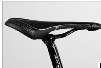
Beim **Ein-Schraubensystem (h)** lösen Sie den quer verlaufenden Haltebolzen so weit wie möglich, ohne die Schließmutter auf der anderen Seite der Klemmvorrichtung zu lösen. In der Regel müssen Sie nicht den kompletten Mechanismus auseinandernehmen, wenn er bereits mit der passenden Außenklemme für den Sattel ausgestattet ist.
