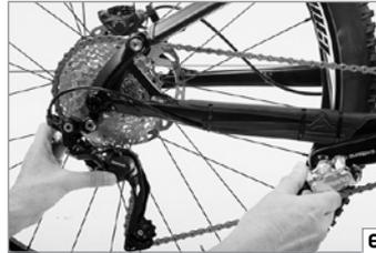
5. Lassen Sie Ihr MERIDA Fahrrad aus geringer Höhe auf den Boden springen. Gehen Sie auftretenden Klappergeräuschen nach. Prüfen Sie ggf. Lager und Schraubverbindungen. Drehen Sie diese ggf. etwas an.
