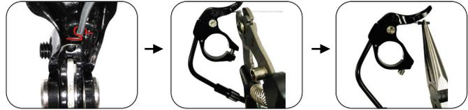
8. Drücken Sie den Hebel 5–10 Mal, um ein eventuelles Lösen des Kabelzugs zu verhindern.
