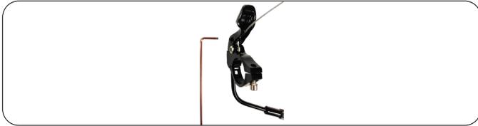
7. Ziehen Sie am Kabelzug, bis dieser fest sitzt und fixieren Sie die Schraube mit einem 2-mm-Inbusschlüssel.
