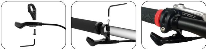
Montieren Sie den Hebel nur auf der linken Lenkerseite (linke Hand des Fahrers). Befestigen Sie den Klemmhebel mit einem 3-mm-Inbusschlüssel am Lenker.
