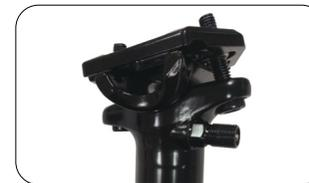
Basierend auf dem unterschiedlichen Gewicht des Fahrers, lässt sich der empfohlene Druck (die Steifigkeit der Federung) aus der rechts aufgeführten Tabelle ablesen. Der Bereich kann zwischen 200 und 300 psi gewählt werden.
